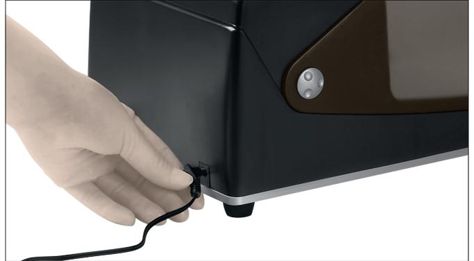
Acople el extremo de la conexión neumática al conector de aire de la parte posterior del módulo; a continuación, acople la boquilla de la conexión neumática al suministro de aire. Ajuste la presión de suministro de aire de 5 a 10 bares.
