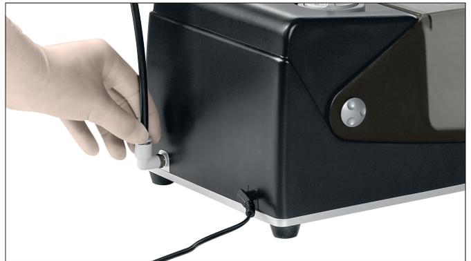
Llene del depósito de aceite con aceite de mantenimiento Synthes, 40 ml, para EPD y APD (05.001.095), como se explica en el apartado Cuidado y mantenimiento.
